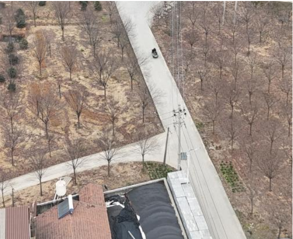
图 4-32 被交路缺少道口标柱、停车让行标志
