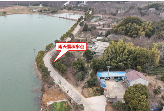
图 4-18 K3+160 北侧无排水设施，雨天易积水
